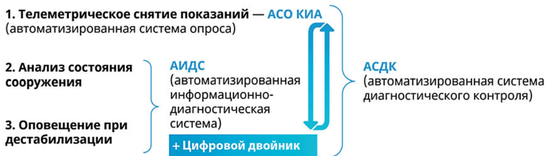
Рис. 1. Структура системы мониторинга ГТС. Схема подключения цифрового двойника
